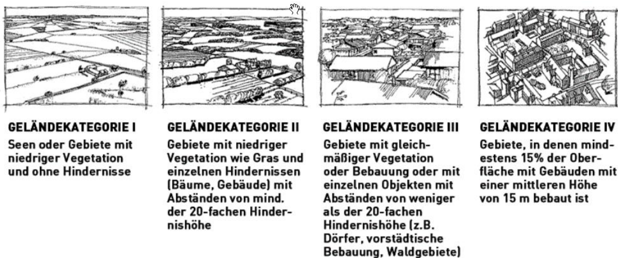
Abbildung 35: Geländekategorisierung nach EN 1991-1-4:2005, Anhang A
