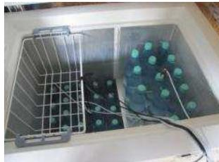
**Abbildung 4** – Kühltruhe in der Klimakammer während der Parameterbestimmung
