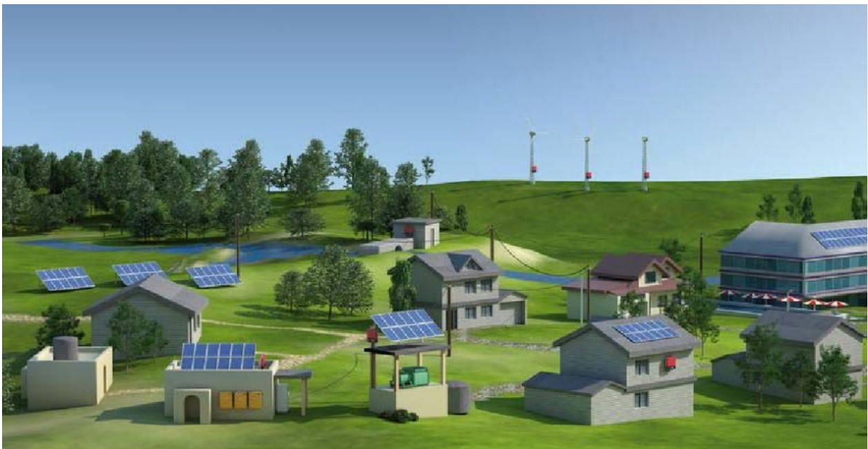
Abbildung 14: PV-Hybrid-Inselnetz © SMA Solar Technology AG
