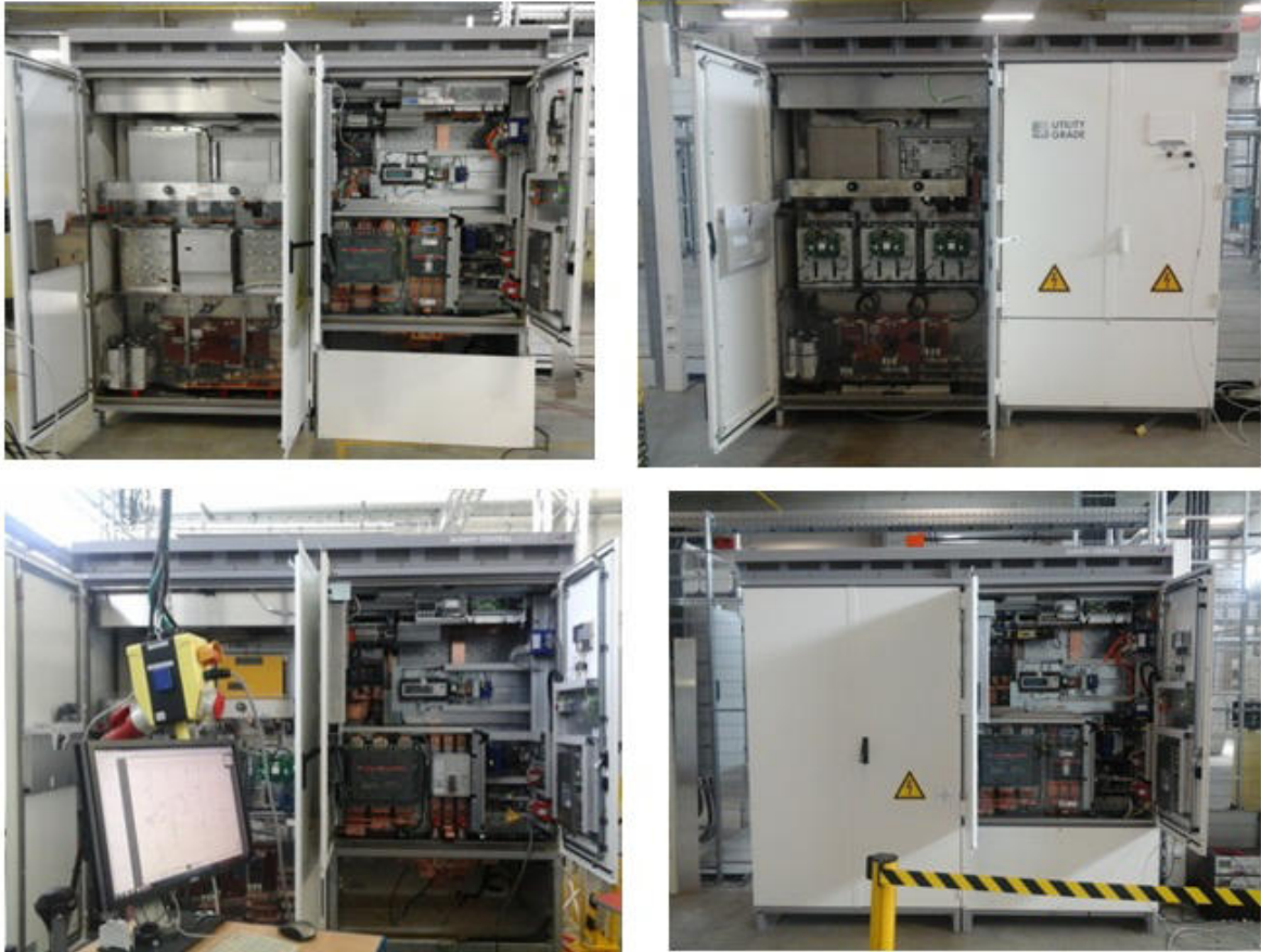
Abbildung 2.12.: Labormuster Batteriewechselrichter zur Durchführung von Tests.
