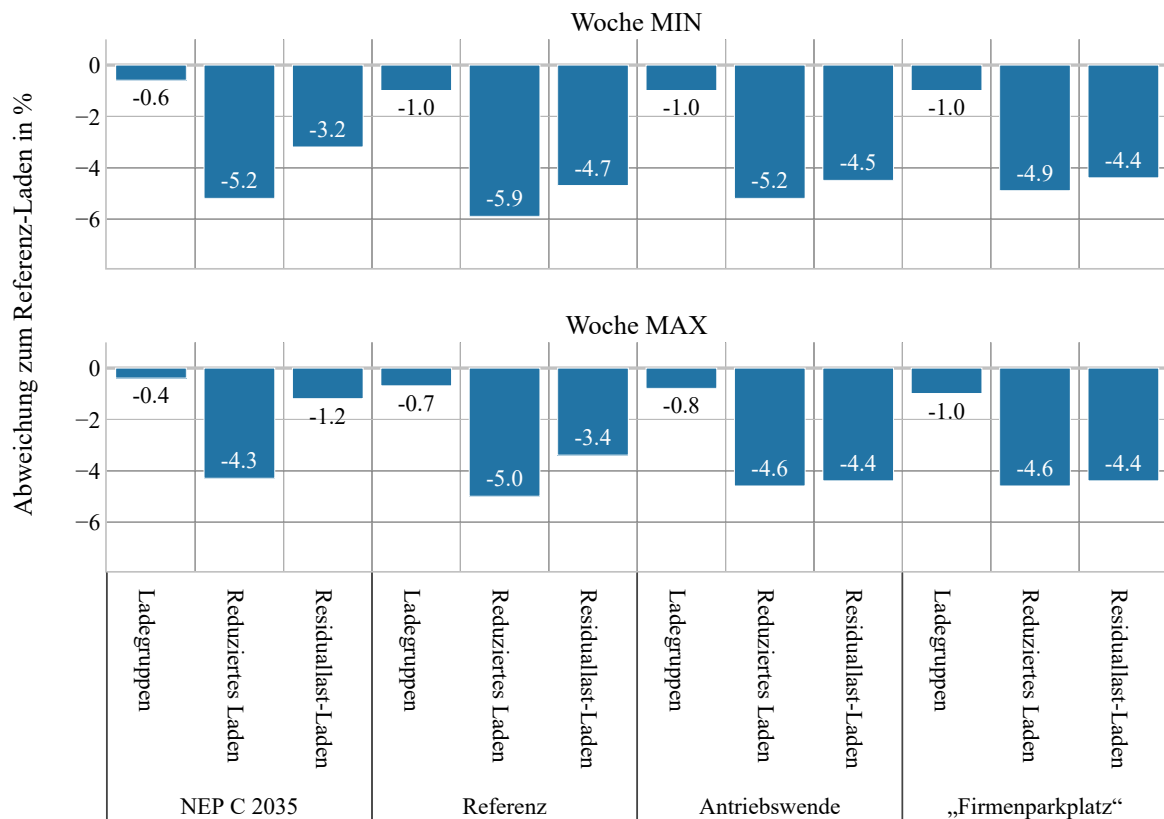
Abbildung 27.: Prozentuale Veränderung des Abregelungsbedarfs von allen Lasten in Abhängigkeit von der Ladestrategie in Woche MIN (oben) und Woche MAX (unten) gegenüber dem Abregelungsbedarf für die Referenz-Ladestrategie je Szenario für das Netz 177 L
