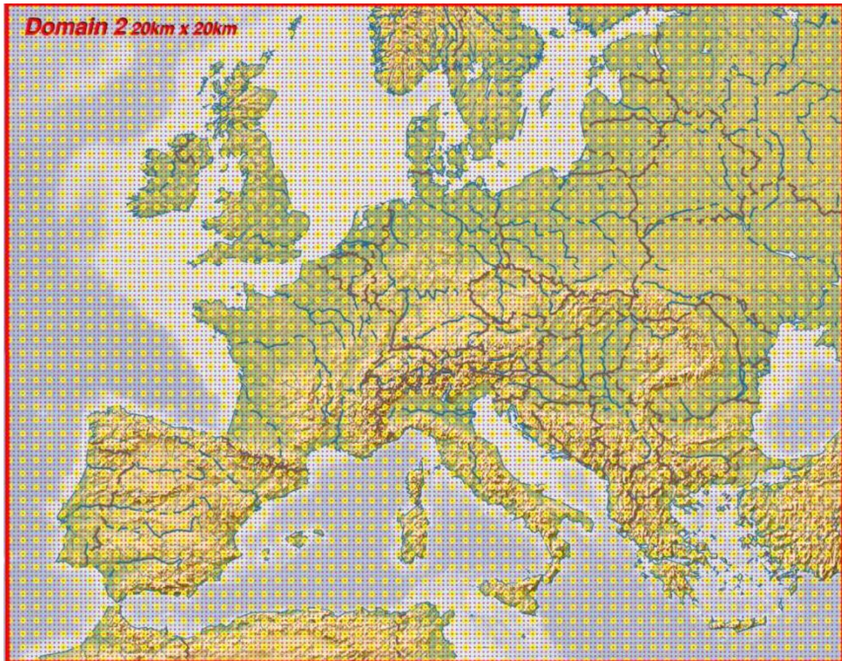
Abbildung 24: Datenpunkte im 60 km-Raster (gelb) und 20 km-Raster (rot), für die Winddaten im ANEMOS-Windatlas vorliegen (Quelle: Anemos Windatlas)
